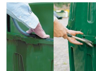
**Dichtung einsetzen. Tankhälften verbinden.**
