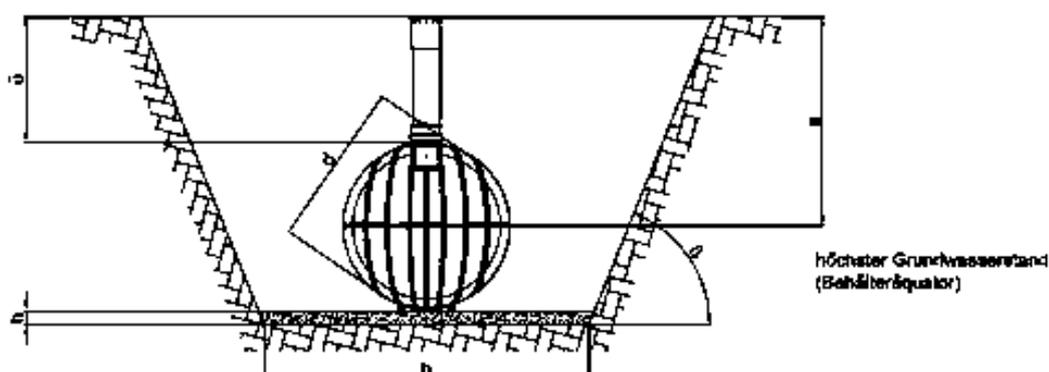
**a** = Abstand Geländeoberkante zu höchstem Grundwasserstand (Behälteräquator)
