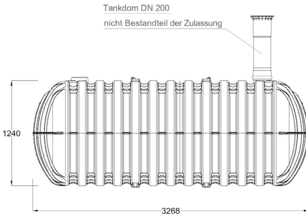
Abflusslose Sammelgrube aus Polyethylen (PE) für die Lagerung von häuslichem
