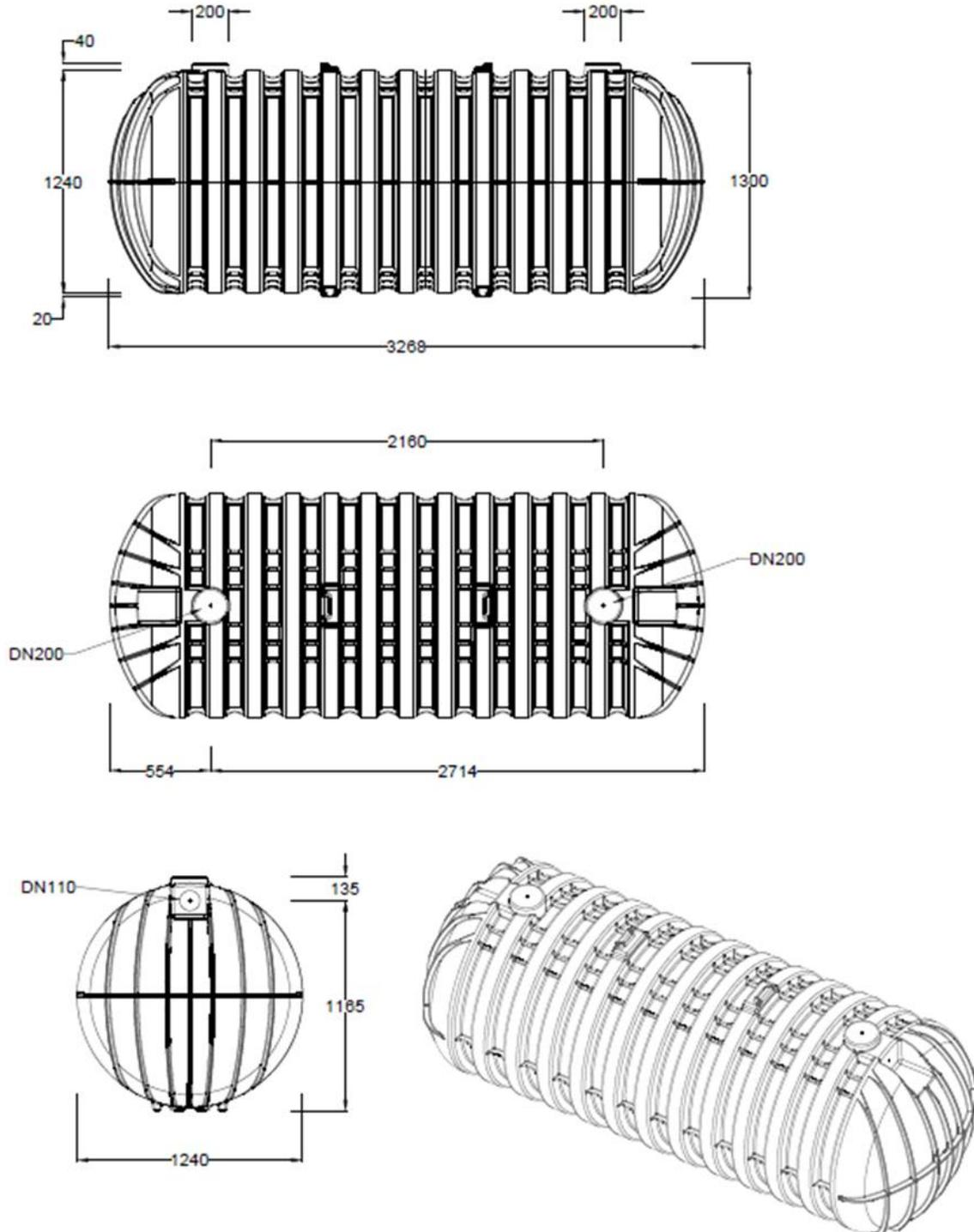
Abflusslose Sammelgrube aus Polyethylen (PE) für die Lagerung von häuslichem Abwasser Typ: "Stabilus" 3000 l
